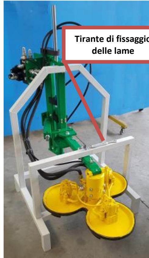
Tirante di fissaggio delle lame
