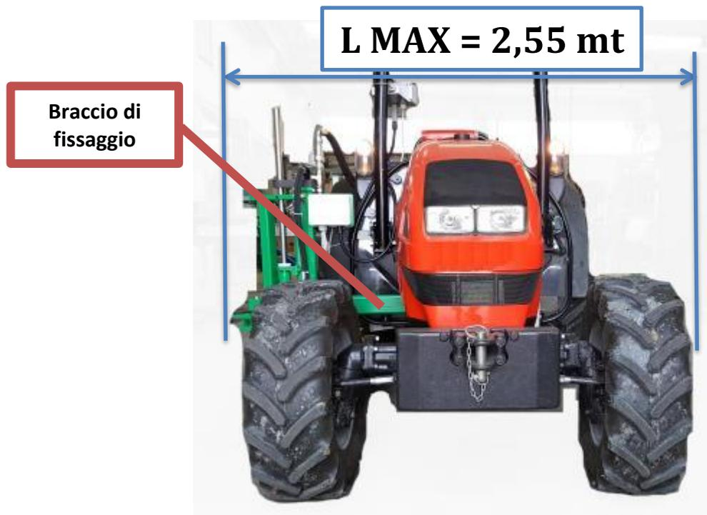
Dimensionare correttamente il braccio di fissaggio alla macchina agricola in modo che la larghezza L della macchina agricola in posizione CHIUSA sia conforme al Codice di Circolazione stradale.
