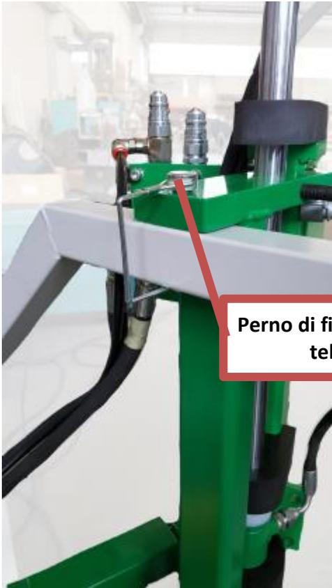
Perno di fissaggio del telaio
